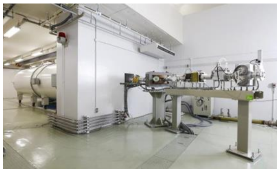
図1 加速器と第一ビームライン輸送系[1]
